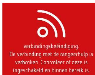
De verbinding met de App Controller werd onderbroken. Zorg ervoor dat de stroom is ingeschakeld. Verklein de afstand tot de Bluetooth-module. Wijzig indien nodig de positie van de module om de ontvangst te verbeteren. Open, eventueel, alle met aluminium beklede jaloezieën.
